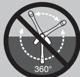
L'amplitude de mouvement (latéral) de deux bras installés sur un poteau à l'aide du support de fixation au bureau est limitée à 180° au-dessus de la partie avant de la base du support. (Voir Instructions d'assemblage, Étape 4.)
