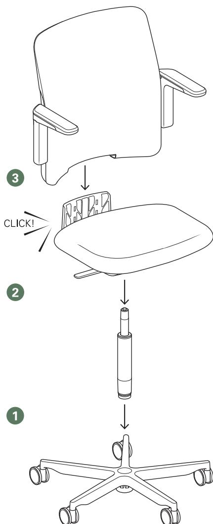
1 Instale el cilindro de gas en el conjunto de la base.
