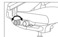
**Tensão da basculação** – Permite-lhe ajustar a força exigida para manter a costa da cadeira direita ou reclinada. Rode o manipulador para a frente e para trás para aumentar e diminuir a resistência exercida pela costa.
