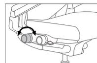
**Tension de basculement** – Permet d'ajuster la force nécessaire pour incliner le dossier. Tournez la molette vers l'avant pour augmenter la résistance et vers l'arrière pour la diminuer.
