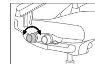
**Tensión de basculación** – Permite regular la resistencia del respaldo en función de su peso, tanto para sentarse en posición avanzada como para inclinarse. Gire la palanca hacia adelante para aumentar la resistencia, hacia atrás para disminuirla.
